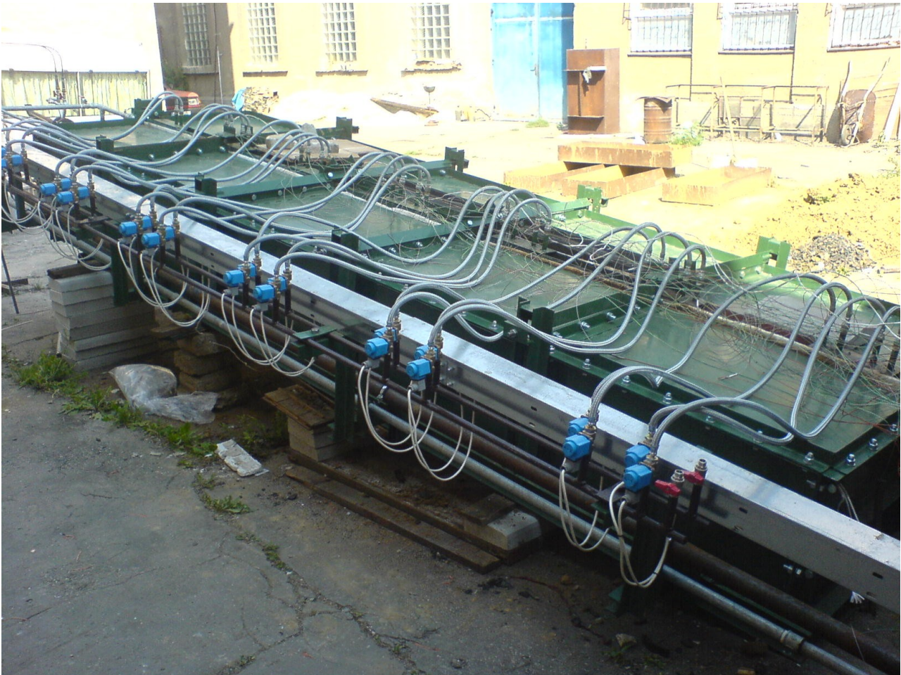
Obr.1 Splyňovací generátor. Hrubé hadicové prívody monitorujú tlakové podmienky a tenké drôtové prívody sú spojené s termočlánkami, uložené do podložia a nadložia uhoľného sloja a do vlastného uhoľného sloja.
